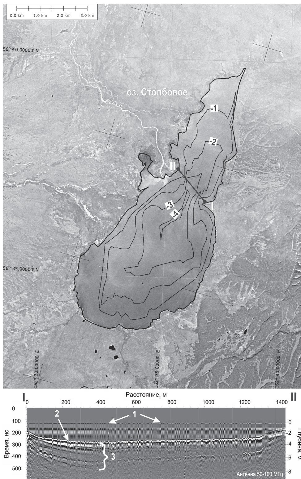
Рис. 5. Строение котловины оз. Столбовое: А — батиметрическая карта по результатам эхолотирования; Б — георадарный профиль по линии I–II: 1 — уровень водной поверхности, 2 — поверхность дна, 3 — пачка субгоризонтально залегающих озерных отложений
