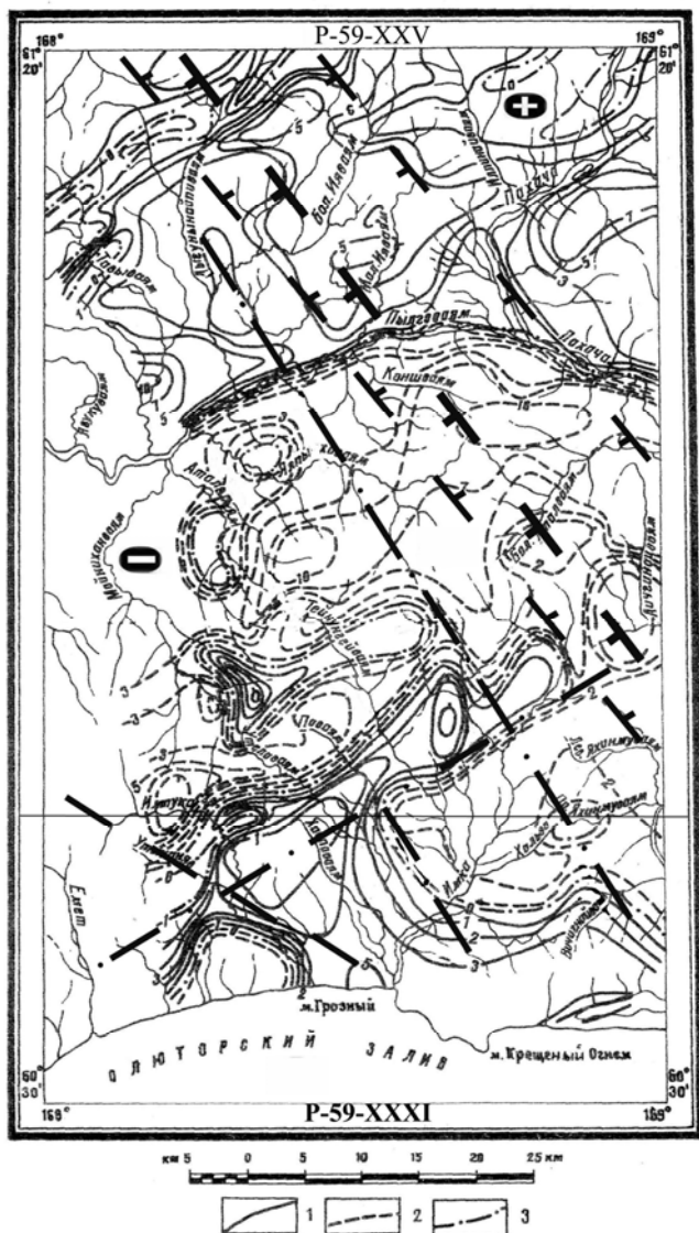
Рис. 118. Карта магнитного поля. Листы P-59-XXV, XXXI. Изолинии ( \Delta T ) \alpha в мЭ: 1 – положительные; 2 – отрицательные; 3 – нулевые
