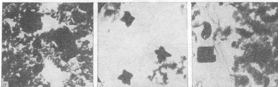
Фиг. 64. Каолинит. Электронно-микроскопические снимки. X2400:
