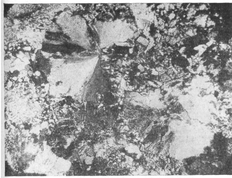
Рис. 3. Своеобразная микропегматитовая структура пород субвулканических куполов (ярко фиксируются веерообразные формы). Ув. 70, никали скрещены
