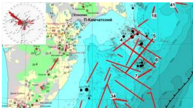
Рисунок 1 – Следы сейсмически активных разломов на плоскости глубины 3 км. Программа Frac-Digger с параметрами N = 6 , \delta t = \infty , \delta Z = 10 км, \delta R = 100 км.
