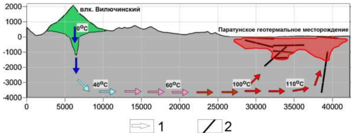
Рисунок 1 – Модель геофильтрационной структуры Паратунского геотермального месторождения в поперечном сечении от вулкана Вилючинский до Паратунского геотермального месторождения. 1 – приток метеорных вод; 2 – продуктивные трещины месторождения.[2]
