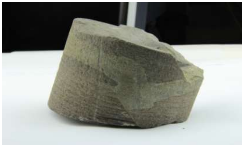
Рисунок 3 – Тектоническая трещина, заполненная мелкокристаллическим кальцитом
