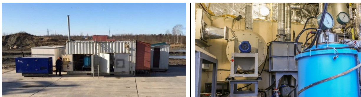
Рисунок 2 – Контейнерное исполнение модульного энергетического комплекса по переработке ТКО электрической мощностью 30 кВт
