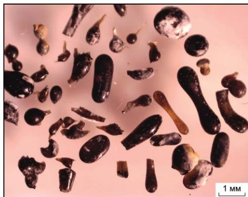
Рис. 2. Частицы вулканического стекла, выделенные из кремнисто-цеолитовых отложений Паужетского геотермального месторождения (скважина R-122). Снимок с использованием цифрового микроскопа Levenhuk DTX 90.
