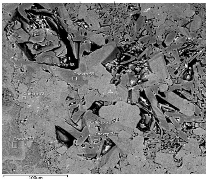
Рис. 2. Электронно-микроскопическое изображение зональности состава алунита.
