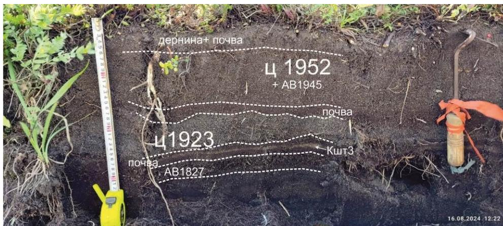
Рис. 3. Отложения цунами 1923 и 1952 гг. Горизонт отложений цунами 1923 г. состоит из чистого песка, горизонт 1952 г. перемешан со шлаком АВ 1945 и отделен почвой от горизонта цунами 1923 г.
