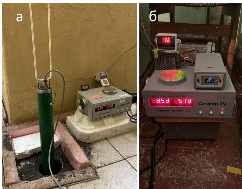
Рис. 1. а – пункт наблюдений в здании ИВиС («Сапфир-3м», датчик радона ВМС-2; б – пункт наблюдений в здании «Стационарная сейсмическая станция Петропавловск» («Сапфир-3м», датчик радона Radex).
