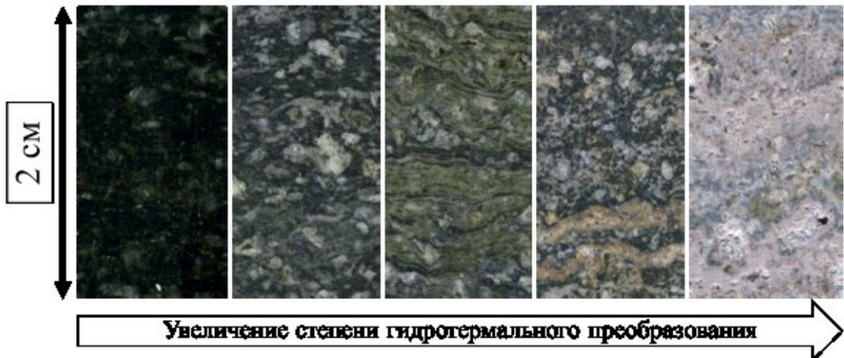
Рис. 3. Образцы различной степени гидротермальной преобразованности, отобранные из стенки отрыва и из тела обвала.
