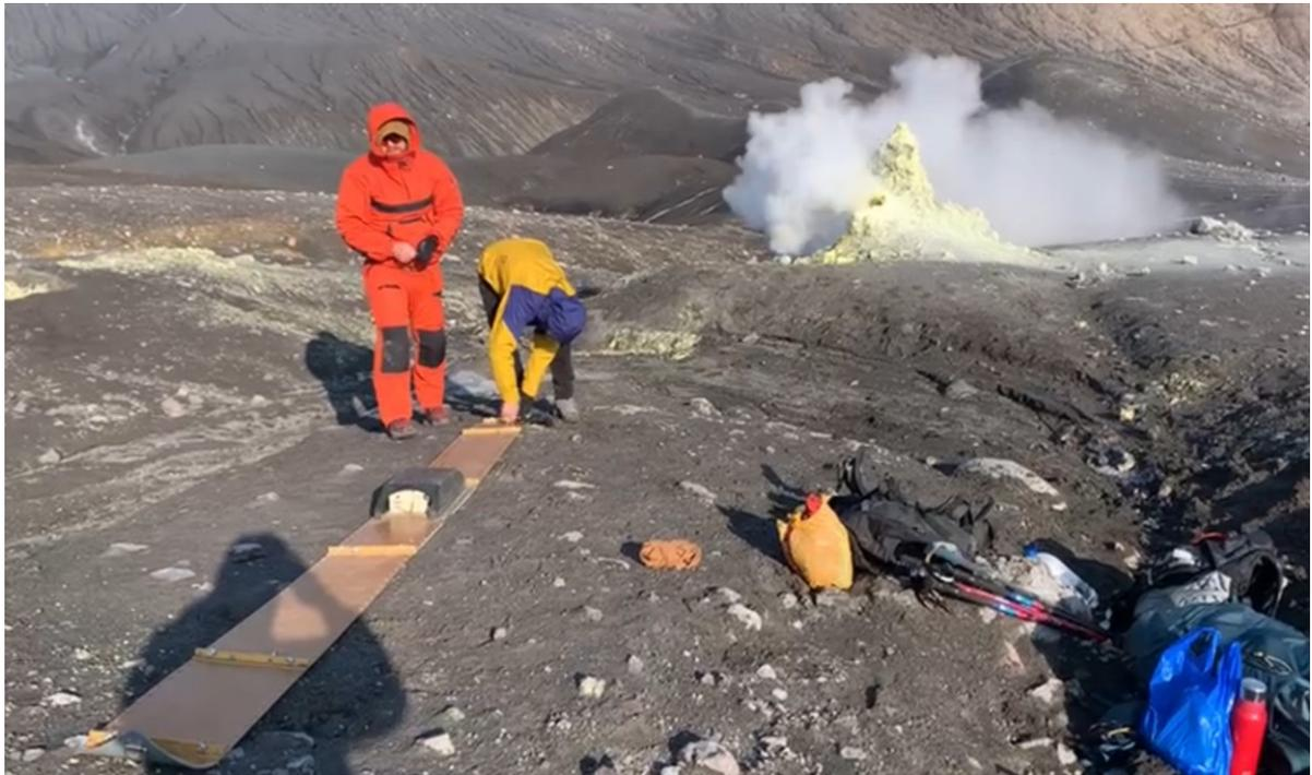
Рисунок. Проведение полевых работ с георадаром «ПИТОН-3» на юго-восточном фумарольном поле вулкана Эбеко.
