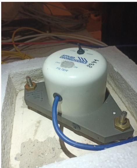
Рис. 1. Общий вид наклономера Applied Geomechanics 701-2, установленного на постаменте пункта комплексных геофизических наблюдений «Карымшина» в 2023 г.
