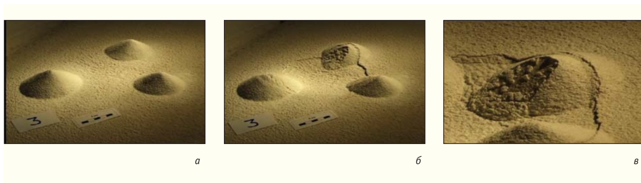
Рис.7. Воспроизведение процесса образования кальдеры на модели из песка: а — до образования кальдеры; б — после; в — увеличенное изображение обвалившегося конуса.
