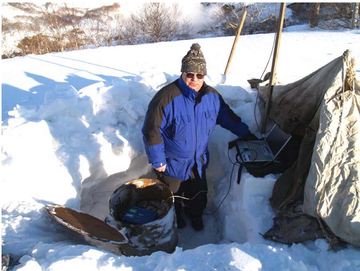
Рис. 1. Установка временной сейсмической станции в Долине Гейзеров. Аппаратура помещена в защитный металлический корпус без дна. Блок сейсмометров установлен внизу, непосредственно на мерзлом грунте, без дополнительного фундамента. Для запуска станции в рабочий режим к цифровому регистратору подключен персональный компьютер
