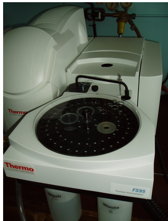
Рис. 1. Автосамплер и электротермический атомизатор атомно-абсорбционного спектрофотометра «ThermoElectron SOLAAR M»
