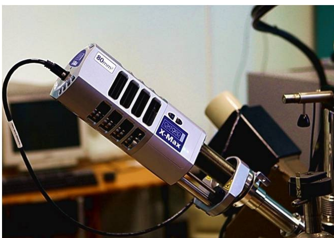
Рис. 4. Аналитическая система Camebax, укомплектованная новейшим энергодисперсионным спектрометром Oxford Instruments X-max 80.
