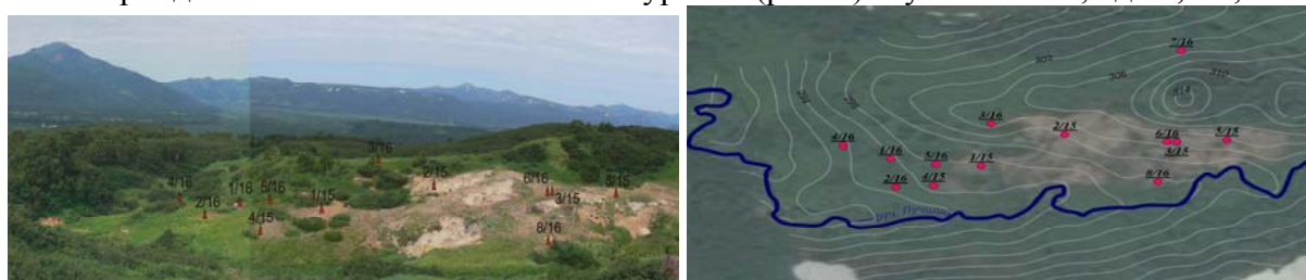
Рис. 1. Восточно-Паужетское т/п: а – общий вид и расположение скважин, б – план с местоположением скважин и их номерами.
