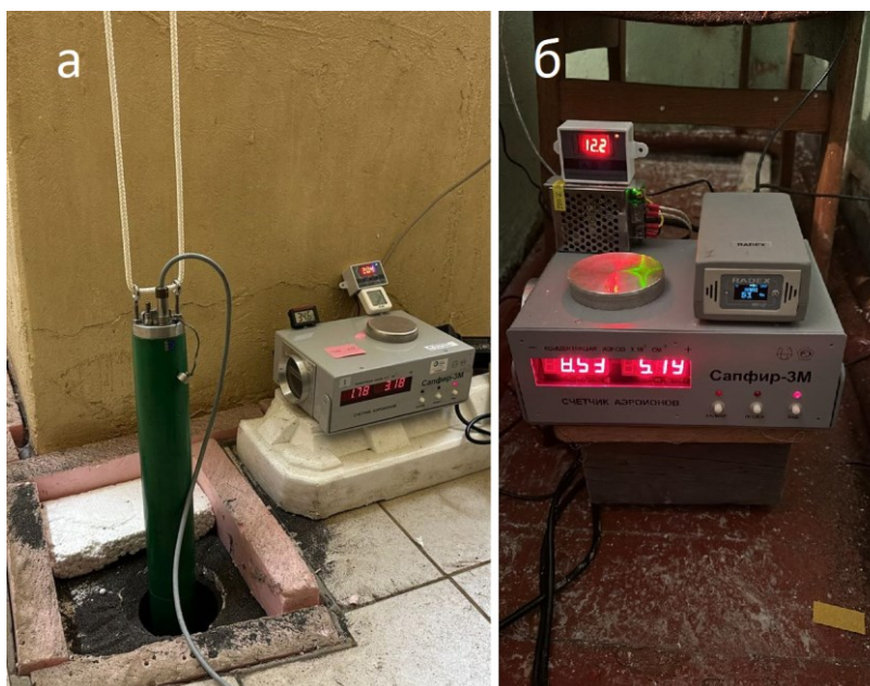
Рис. 1. а – пункт наблюдений в здании ИВиС («Сапфир-3м», датчик радона VMS-2; б – пункт наблюдений в здании «Стационарная сейсмическая станция Петропавловск» («Сапфир-3м», датчик радона Radex).
