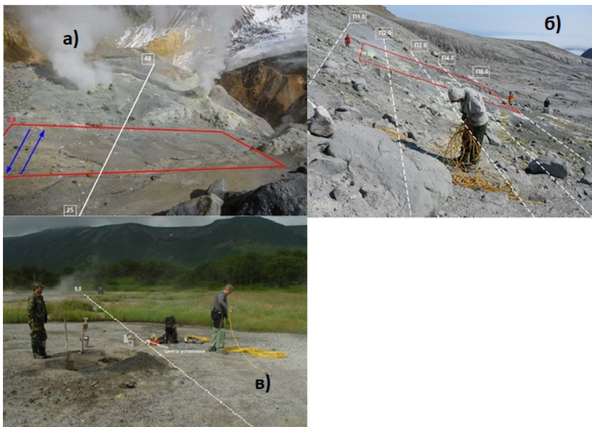
Рис. 1. Взаимное расположение профилей ЧЗ и электротомографии на а) Донном поле Северо-Восточного картера вулкана Мутновский, б) Северо-Восточном поле вулкана Эбеко, в) Нефтяном поле в кальдере Узон.
