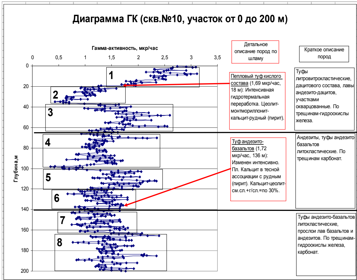
Рис.3. Пример интерпретация диаграммы ГК. Условные обозначения: 1, 2 и т.д. – границы участков по изменениям гамма-активности; — - граница раздела по типам горных пород.
