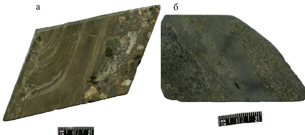
Рис. 6. а - сочетание брекчиевой с полосчатой; б - вкрапленной с полосчатой. Полированные штуфы.
