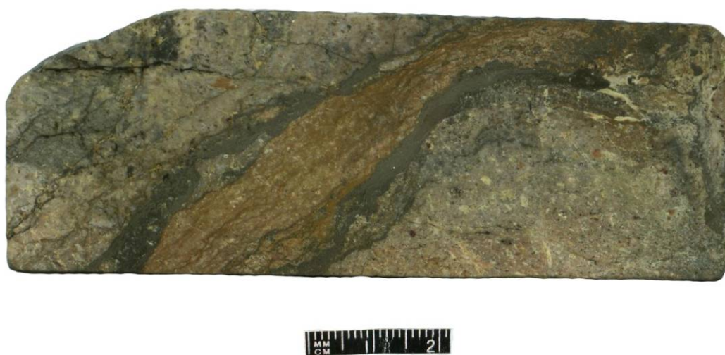
Рис. 7. Вкрапленная с элементами «псевдофлюидальной» и прожилковой текстура. Полированный штуф.
