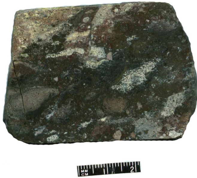
Рис. 4. Брекчиевая текстура с элементами гнездово-вкрапленной. Полированный штвф.
