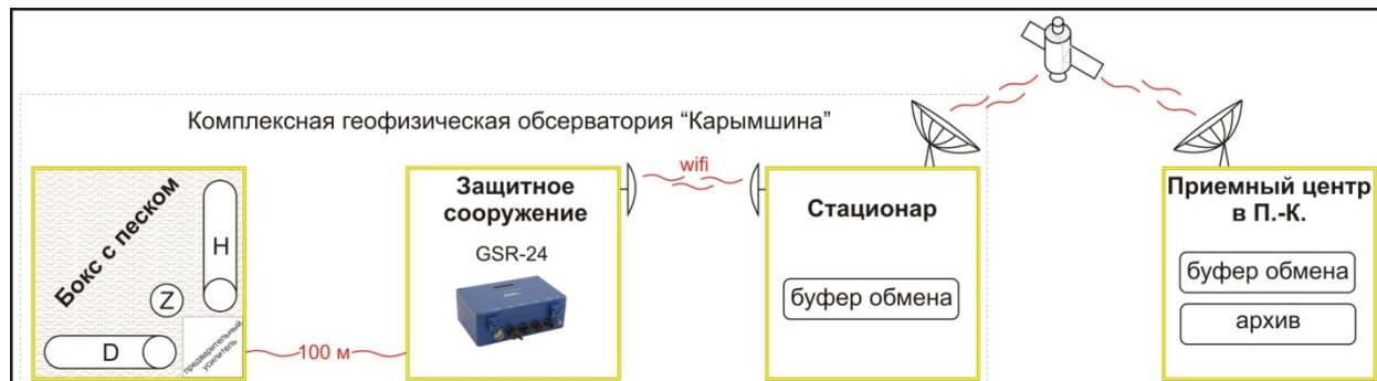
Рис. 2. Схема передачи данных геомагнитных наблюдений
