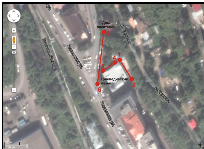
Рис. 5. Схема расположения георадиолокационных профилей. Условные обозначения: 1-2 – профиль 1 (36 м); 3-4 – профиль 2 (29 м); 5-6 – профиль 3 (57 м). Космический снимок Image Landsat, Data SIO, NOAA, U.S. Navy, NGA, GEBCO www.earth.google.com ).
