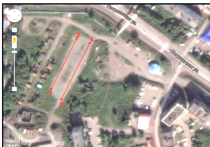
Рис. 10. Схема расположения георадиолокационных профилей. Условные обозначения: 1-2 – профиль 1 (76 м); 3-4 – профиль 2 (80 м).
