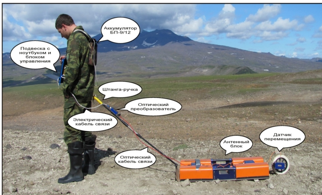
Рис. 2. Состав прибора георадар «ОКО-250».
