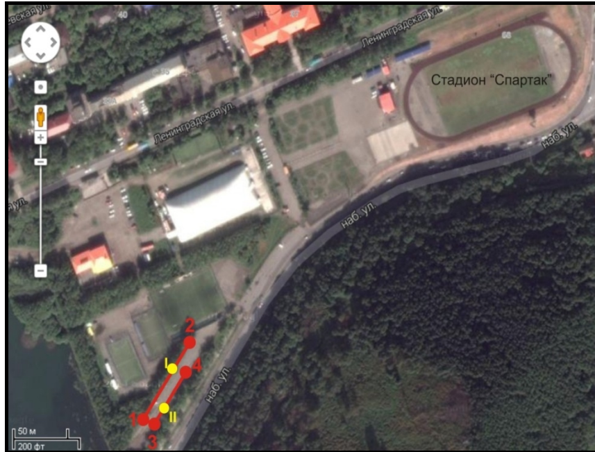
Рис. 7. Схема расположения георадиолокационных профилей. Условные обозначения: 1-2 – профиль 1 (52 м); 3-4 – профиль 2 (39 м); I – скважина С-5329/15; II – скважина С-5332/20. Космический снимок Image Landsat, Data SIO, NOAA, U.S. Navy, NGA, GEBCO www.earth.google.com .
