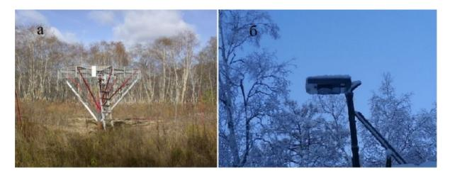
Рис. 2. Общий вид эквипотенциальной поверхности, на которой установлен флюксметр «Поле-2» на обсерватории ПРТ (а), флюксметр ЭФ-4, установленный в КZY обтюратором вниз (б).
