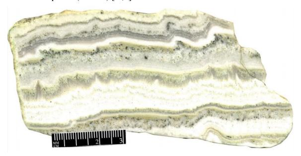
Рис. 1. Типичные руды Агинского месторождения, колломорфно-полосчатая текстура, жильная зона Блуждающая, полированный штуф, H - 1270-1310 м.
