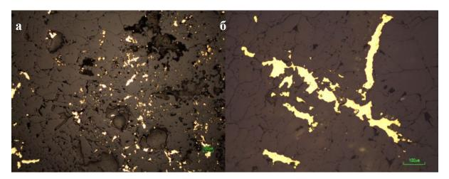
Рис. 4. Формы выделения самородного золота в рудах месторождения: а – «гнездообразное»; б - дендритовидное. Фото в отраженном свете. Горизонт 1130, рудное тело Сюрприз.
