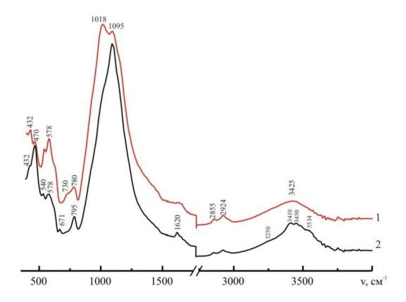
Рис 5. Инфракрасные спектры образцов пеплов вулканов Колима(1) и Жупановского (2)
