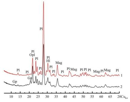
Рис 4. Дифрактограммы образцов пеплов вулканов Колима (1) и Жупановского (2)
