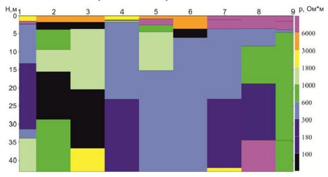
Рис. 8. Вертикальный разрез удельных сопротивлений.
