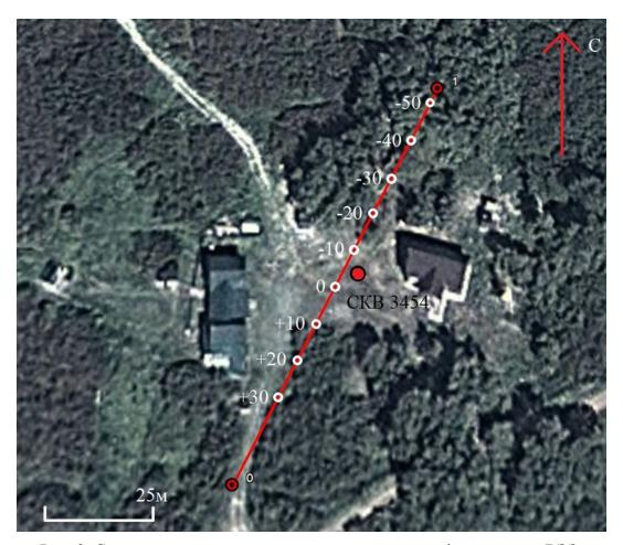
Рис. 2. Схема расположения сейсморазведочного профиля и точек ВЭЗ.
