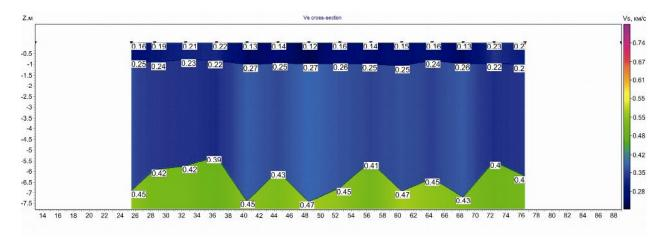
Рис. 7. Скоростное распределение поперечных волн, полученное в результате моделирования по методу MASW
