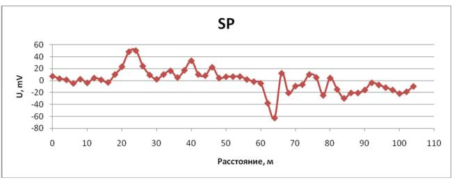
Рис. 9. График распределения потенциала естественного электрического поля.
