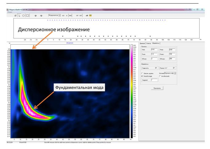
Рис. 3. Рабочее окно модуля «MASW» в программе ZondST2D.
