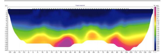
Рис. 5. Сейсмотомографический разрез по продольным волнам, полученный в результате моделирования.
