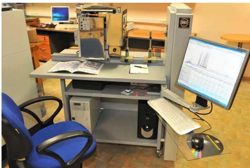
Рис. 1. Компактная передвижная установка для метода просыпки-вдувания.
