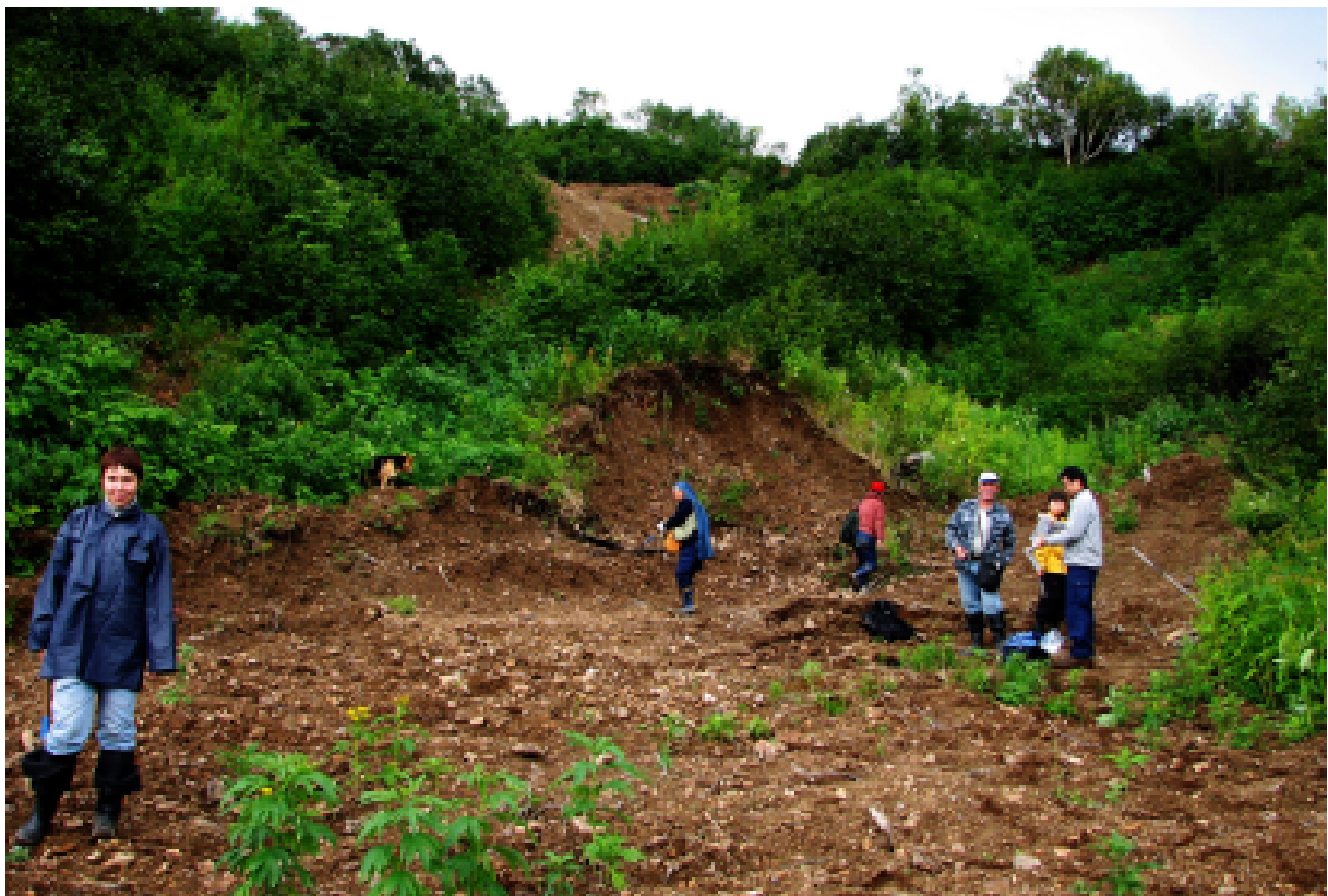
Рис. 7. Магистральная канава по жильной зоне 1 Асачинского месторождения. Где-то там под нами штольня и самые богатые руды. А вокруг - одни рыхлые отложения.
